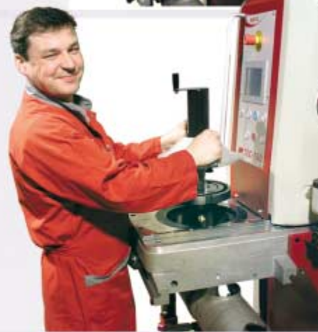
冷拔工作头的更换和支管的冷拔成型
